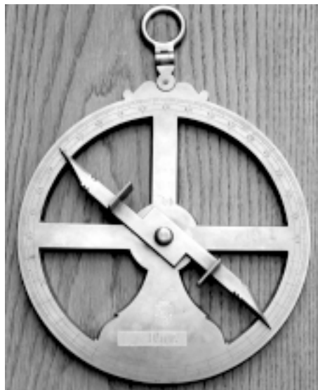
Fig. 5: Eén van de vier replica's van het Skokloster I astrolabium. Het origineel dateert van 1626. Het vizier van de alhidade bestaat uit twee opstaande elementen, met elk een kleine perforatie.
