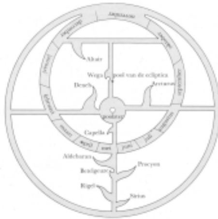
Fig. 2: De spin. Het draaipunt stelt de Poolster voor. Andere duidelijke sterren zijn als punten op de spin aangegeven. De spin wordt over een vaste schijf gelegd, de timpaan, waarop een netwerk van azimutlijnen is getekend voor een gegeven breedtegraad
