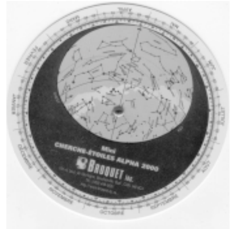
Fig. 4: Een hedendaagse planisfeer. De binnenste kaart geeft de sterrenhemel weer in een stereografische projectie vanuit de Zuidpool. De open uitsparing geeft het deel van de sterrenhemel dat zichtbaar is voor een waarnemer op 52° NB
